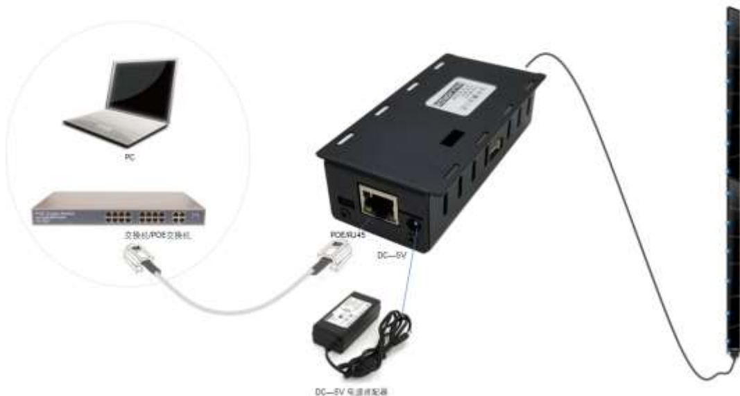
图 4.1.3 WH-RU2000 主机通信及供电连接
